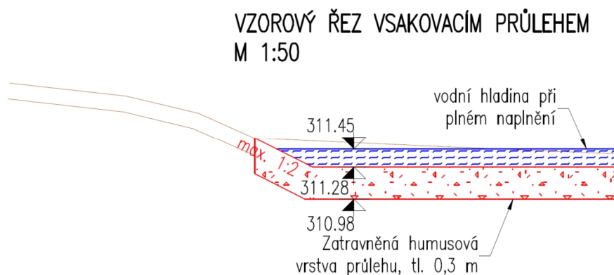
Obr. 8.1 - Vzorový řez vsakovacím průlehem
